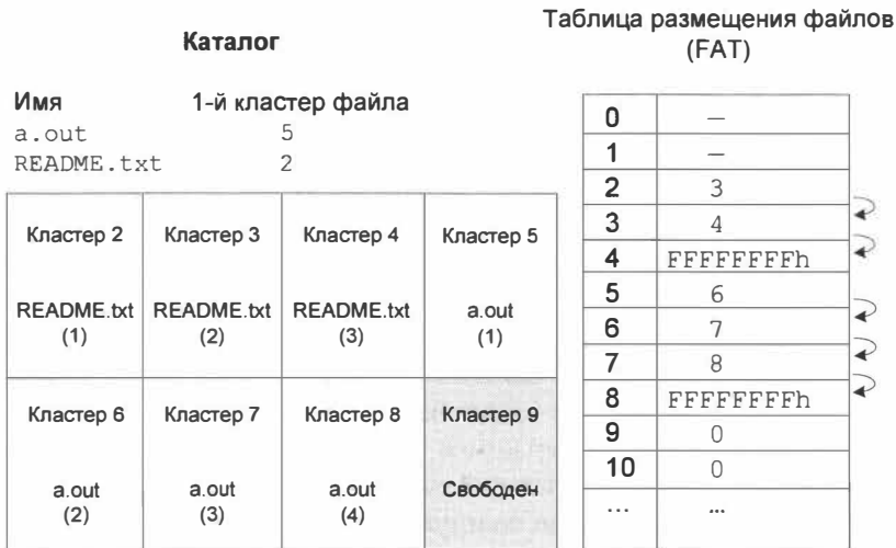
Рис. 10.3. Пример кластерной цепочки в FAT32
