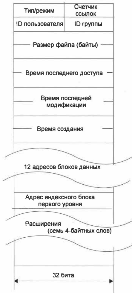
Рис. 9.13. Схематичное изображение inode
