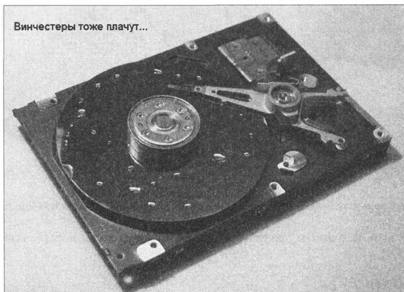
Рис. 1.5. Еще один "запыленный" диск, восстановить который, увы, уже невозможно (публикуется с любезного разрешения владельцев сайта http://www.hdd-info.ru )
